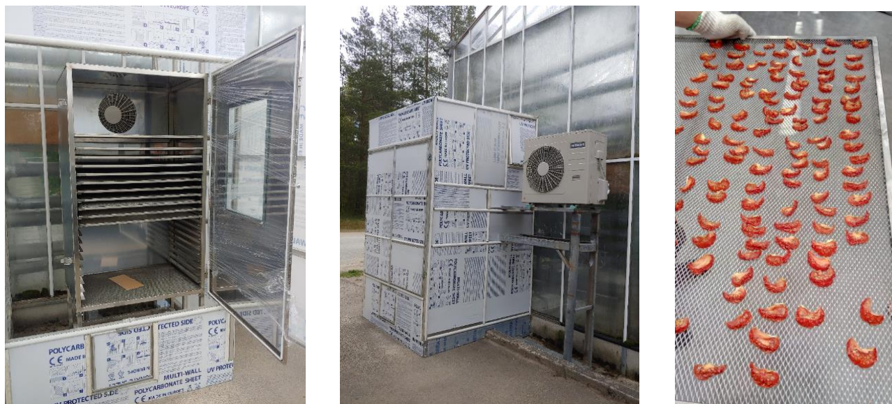
7.16. att. Biomasaš žāvēšanas iekārta un gatavā produkcija
