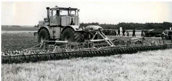
2.12. att. Plattvēriena 5 sekciju uzkarināmais kombinētais S-veida atsperzaru kultivators KP-14 darbā un transportstāvoklī. Darba tvēriens 14 m. Konstruktors Dr.sc.ing. Uldis Pinnis.
