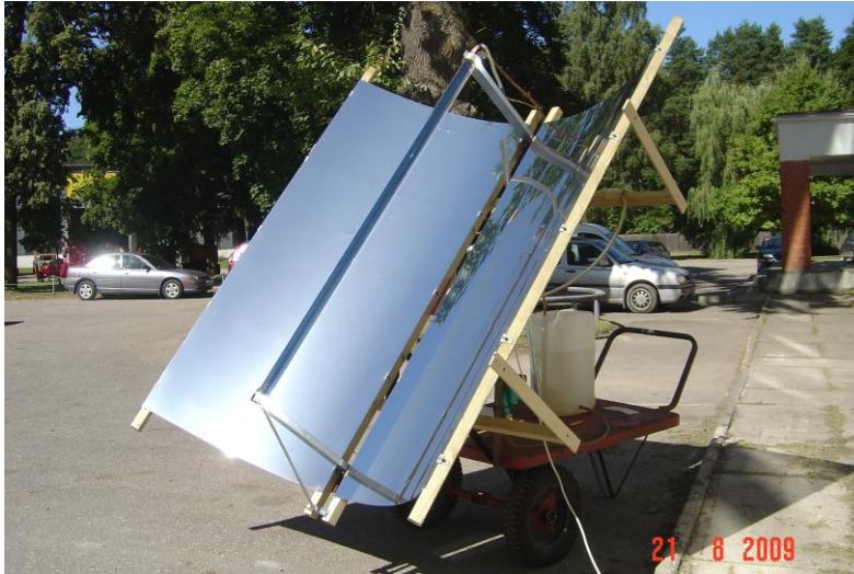
10.7. att. Saules enerģijas kolektors ar paraboliski-cilindriska spoguļa reflektoru (2009).
