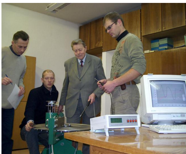
2.15. att. Tribometriskais stends materiālu slīdes pretestības pētījumiem (2004).
