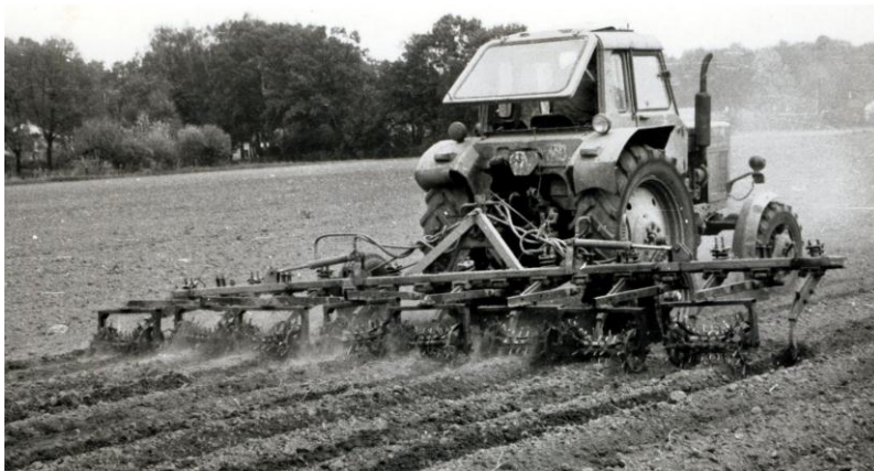
4.1. att. Kartupeļu vagotājs OKN-8 ar koniskām rotējošām ecēšām skaustu irdināšanai darbā. (1986)
