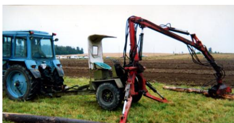
14.1. att. Piekabināmais hidrauliskais iekrāvējs IP-30 (~1994)
