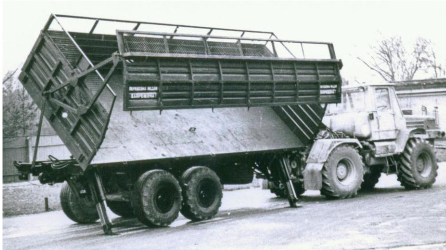
2.3. att. 16 t vestspējas seglu piekabe ar automātiski atveramu sānu bortu organiskā mēslojuma, skābarības masas u.c. lauksaimniecības kravu pārvadāšanai (~1976).
