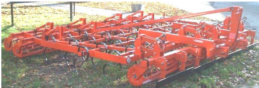
2.7. att. Kombinētais uzkarināmais kultivators ar S-veida atsperzariem KU-4. Kultivatora darba tvēriens 4 metri (~2000).
