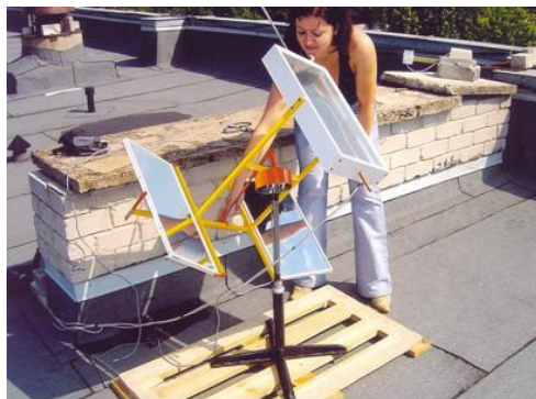
10.4. att. Saules enerģijas kolektorierīce ar atstarotājiem (patents LV 13549, 2007.)
