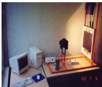
10.2. att. Kolektoru pētīšanas stends (2005)
