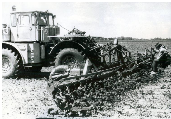
2.2. att. Triju sekciju 36 rindu agregāts ar hidroficētu stūres iekārtu cukurbiešu rindstarpu apstrādē (~ 1980).
